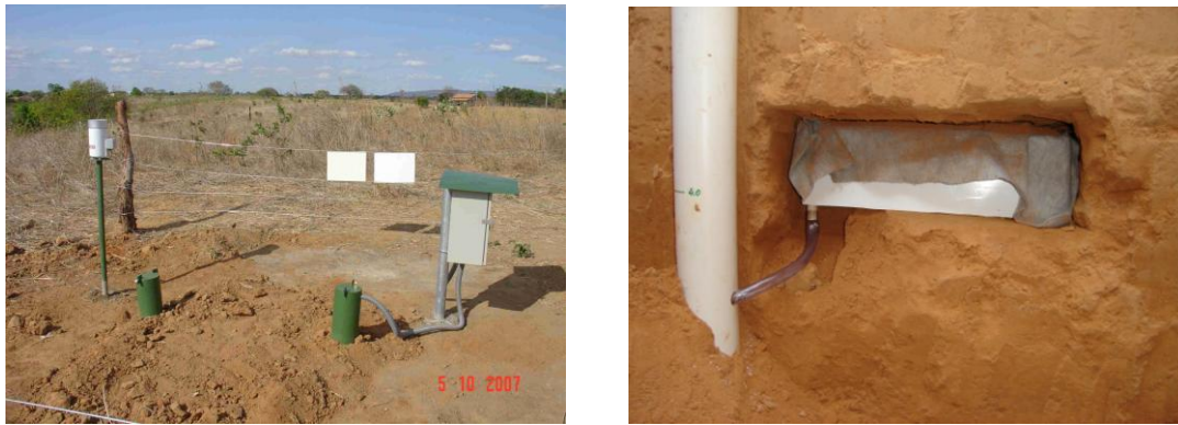
Figura 5 –Instalação completa de estação com infiltrômetros de gaveta. À direita detalhe da gaveta com tubo reservatório (Autor: Peter M. Fleming, 2007)
