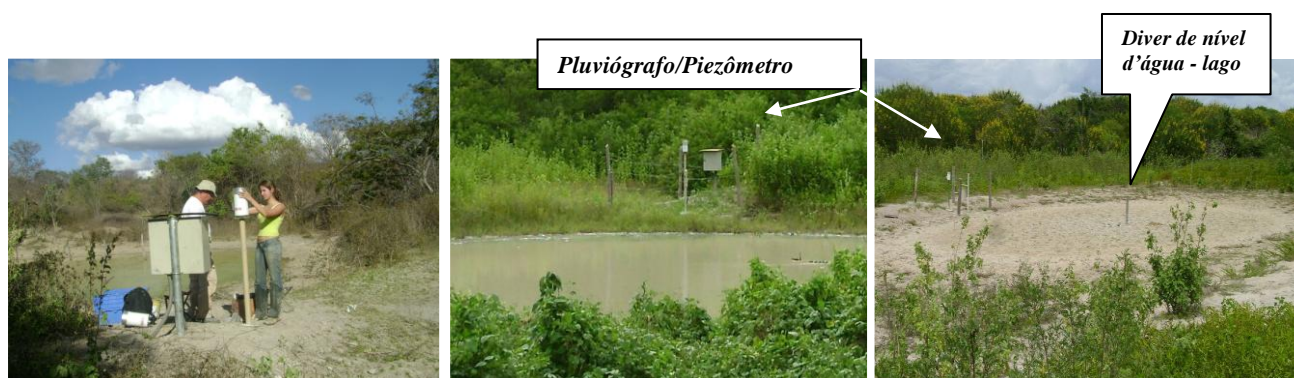
Figura 7 – Estações de monitoramento hidrológico nas dolinas das Fazendas Santana (meio) e Pedro Moura ( dir.)
