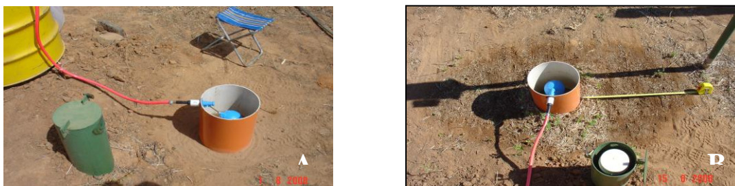
Figura 6 - (A) Esquema de infiltração artificial na estação P1 Faz. D. Domina. (B) Detalhes da bóia controladora de entrada de água e bulbo de umidade. (Autor: Peter M.F., 2008)
