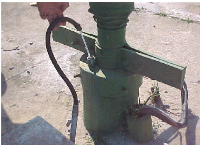
Um tubo em polipropileno, de pequeno diâmetro, aberto na extremidade, é descido no poço e mergulhado abaixo do nível a ser medido ( ponto zero ).
