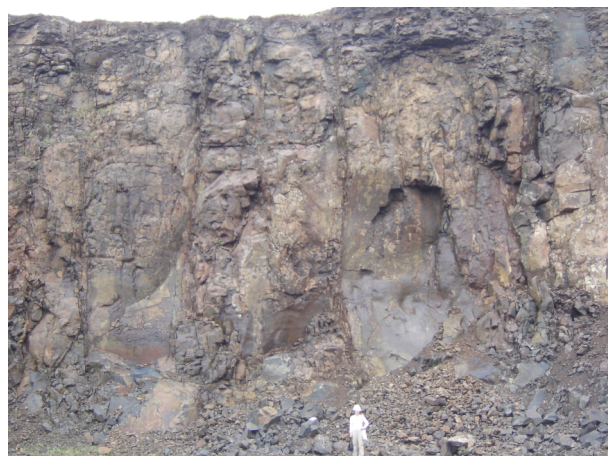
Figuras 7 e 8. Fraturas e zonas de fraturas verticais, provavelmente tectônicas, apresentam alteração (cor ocre na foto 3) até, pelo menos, 25 m de profundidade.
