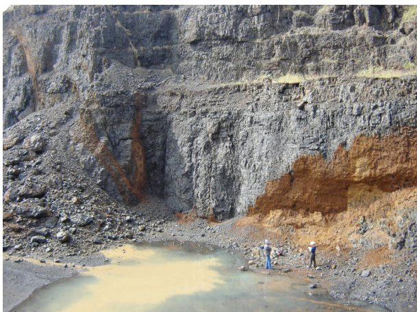
Figuras 7 e 8. Fraturas e zonas de fraturas verticais, provavelmente tectônicas, apresentam alteração (cor ocre na foto 3) até, pelo menos, 25 m de profundidade.
