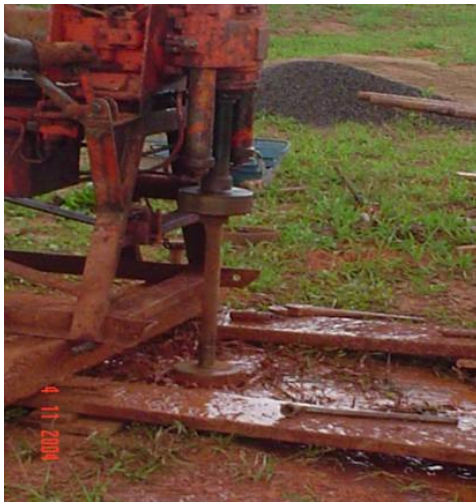
Figuras 5a e 5b: Perfuração do solo com equipamento mecânico e trado tipo hélice utilizado na perfuração manual, respectivamente.
