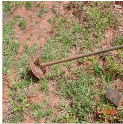
Figuras 5a e 5b: Perfuração do solo com equipamento mecânico e trado tipo hélice utilizado na perfuração manual, respectivamente.
