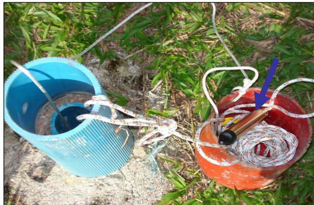
Figura 10 – Foto do transdutor de pressão Barologger indicado por uma seta azul.
