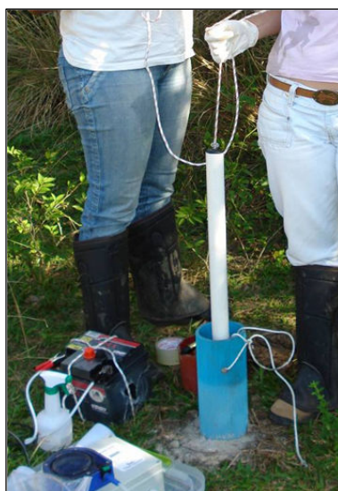
Figura 08 - Foto da inserção do sólido no piezômetro ( slug test ).
