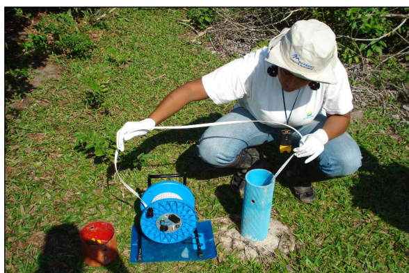
Figura 07 – Foto apresentando a medição do nível d'água com medidor eletrônico.
