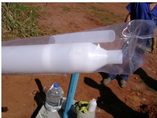
Figura 12: bailer de polietileno descartável. Autor: Yadyr Augusto Figueiredo Filho, abr/2008
