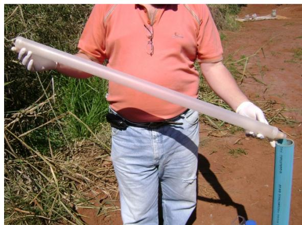
Figura 13: coletando a água com o bailer. Atenção para o uso de luvas descartáveis. Autor: Yadyr Augusto Figueiredo Filho, abr/2008
