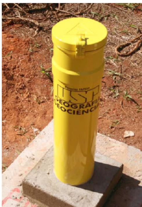
Figura 10: conjunto pronto e sinalizado, com a vedação (selo) de concreto
