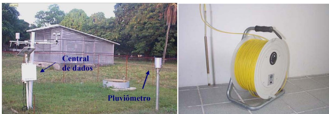
Figura 1. a) Visualização parcial da parcela experimental, com pluviômetro e central de dados e b) Medidor de nível do lençol freático
