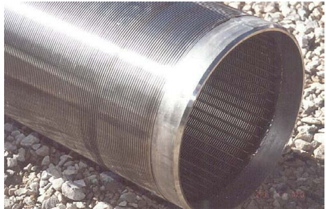
Figura 8 – (ao lado) Filtro em aço inoxidável de tipo ranhura contínua e abertura (“slot”) 1mm.
