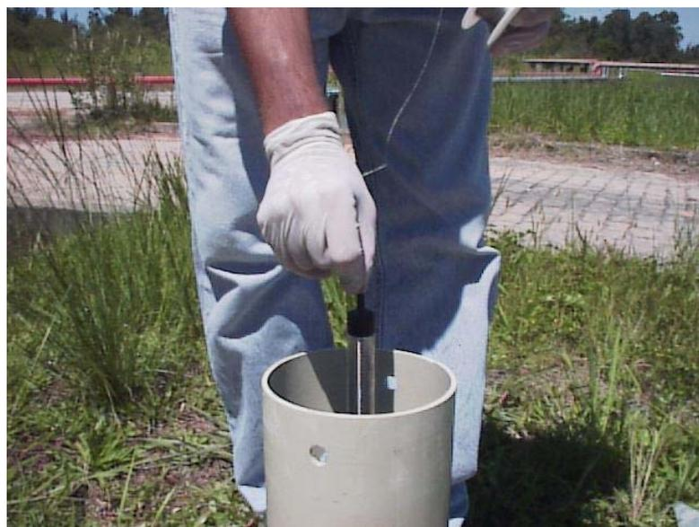
Figura 4 – Medidor automático de nível d'água utilizado nos poços e no canal.
