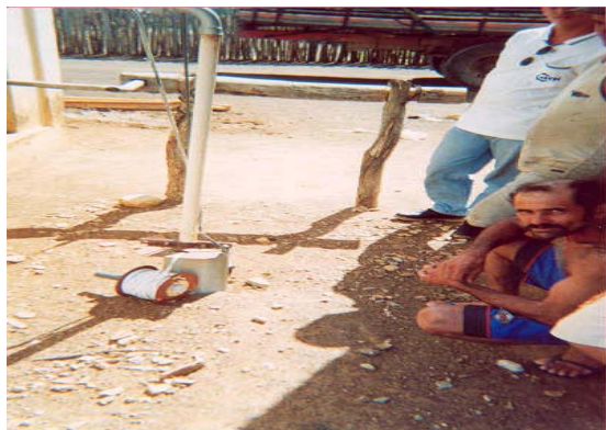
Fotos 3: Medição do nível estático do poço tubular no distrito de Sucupira em Limoeiro do Norte – CE.
