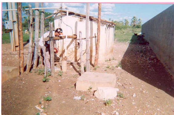
Foto 5: Medição do nível dinâmico do poço tubular no distrito de Sucupira em Limoeiro do Norte – CE.
