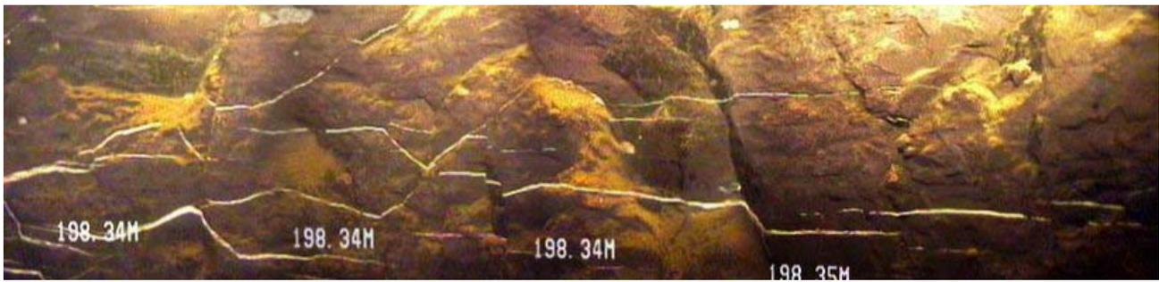
**FOTOGRAMA A1** – Montagem panorâmica mostrando fraturas preenchidas aos 198,34 metros.
