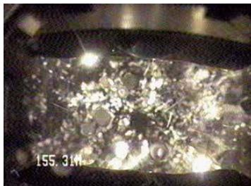
**FOTOGRAMA T** – Visada de fundo aos 155,31 metros, que mostra o nível d'água aos 155,71 metros. Neste local existe outro contato entre basalto maciço e vesicular. Observa-se neste local a quebra no tempo de trânsito (ao lado).
