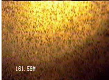
**FOTOGRAMA V** – Visada lateral de Basalto Vesicular (Camada 5A) aos 161,59 m. Neste local as vesículas já estão bem pequenas e aspecto maciço aparente. Nota-se a diminuição do tempo de trânsito. O comportamento dos perfis é parecido ao do basalto maciço.
