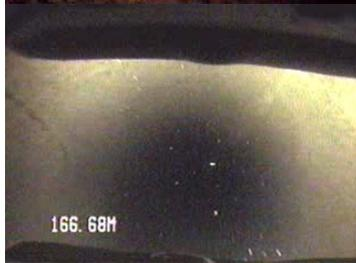
**FOTOGRAMA W** – Visada de fundo do Basalto Maciço (Camada 5B: 163,0 - 172,0 m). Nesta camada o tempo de trânsito é de 57  $\mu$ s/pé e os Raios Gama não mudam muito em relação à base da camada superior vesicular.
