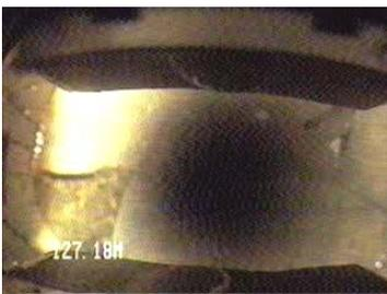
**FOTOGRAMA H** - Visada de fundo do basalto fraturado aos 127,18 metros.
