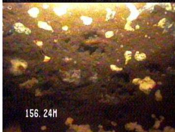
**FOTOGRAMA U** – Visada lateral de Basalto Vesicular (Camada 5A: 155,71 - 163,0 m).
