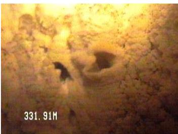
**FOTOGRAMA A20** – Visada lateral de dois dutos, dentro do basalto maciço, por onde se observa intensa produção de água aos 331,91 metros. Na filmagem nota-se turbidez na água que sai pelo mesmo indicando diferentes densidades entre a água do poço e a do duto.
