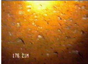
**FOTOGRAMA X** – Visada lateral de Basalto Vesicular (Camada 6A – 172,0 a 181,5 m). A resistividade e o tempo de trânsito diminuem. Notam-se irregularidades no cáliper.
