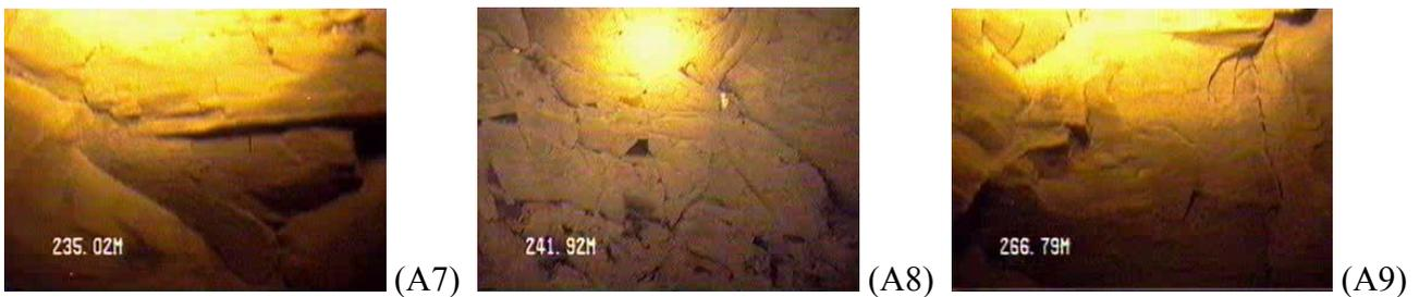
**FOTOGRAMAS A7 a A9** – Visadas laterais do Basalto Maciço com queda de blocos da Zona 8.
