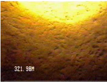
**FOTOGRAMA A18** – Visada lateral do basalto vesicular. Iniciada uma incrustação carbonática.
