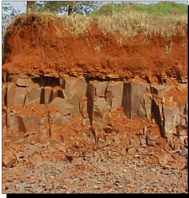
Figura 9: Foto com o perfil de solo e rochas alterada e sã de basalto da Formação Serra Geral, mostrando os fraturamentos horizontais (Foto: Arq. Arlen).
