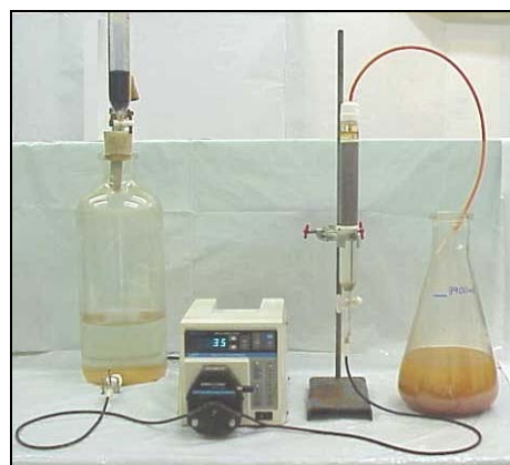
Figura 3: Foto ilustrativa do sistema redutivo de destruição com passagem única
