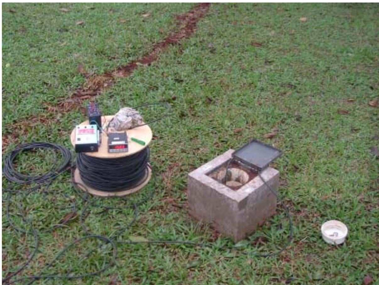
Figura 7 – Equipamentos para medição e armazenamento dos dados de nível d’água no poço
